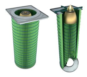
Gold Series X-Flo Gold Cone Filterpatronen sind speziell für den Einsatz in unseren Trockenabscheidern der Gold Series X-Flo entwickelt und verfügen über eine konische Erweiterung im Innern des Filters, die mit zusätzlicher Filterfläche ausgestattet ist. Dadurch können die Filter mehr Staub aufnehmen und abscheiden als vergleichbare Patronenfilter. Gold Series X-Flo Gold Cone Filter sind in unterschiedlichen anwendungsspezifischen Medienausführungen erhältlich.
